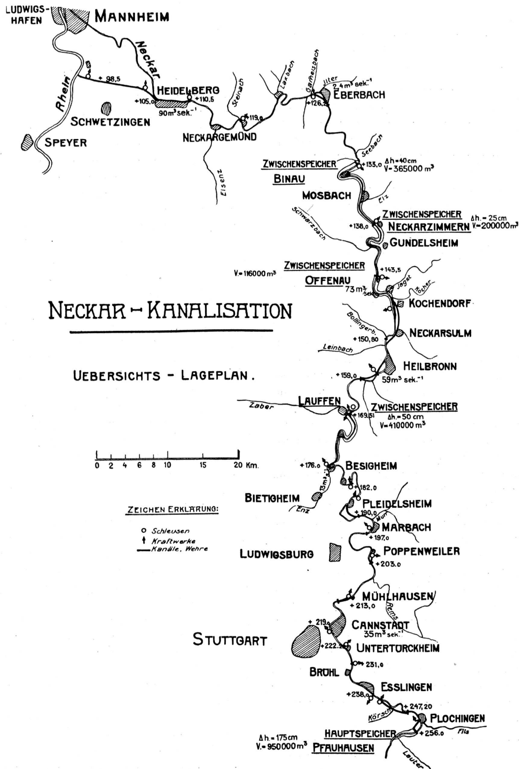
Abb. 1. Neckar-Kanalisation. Uebersichts-Lageplan. Maßstab 1 : 500 000.
