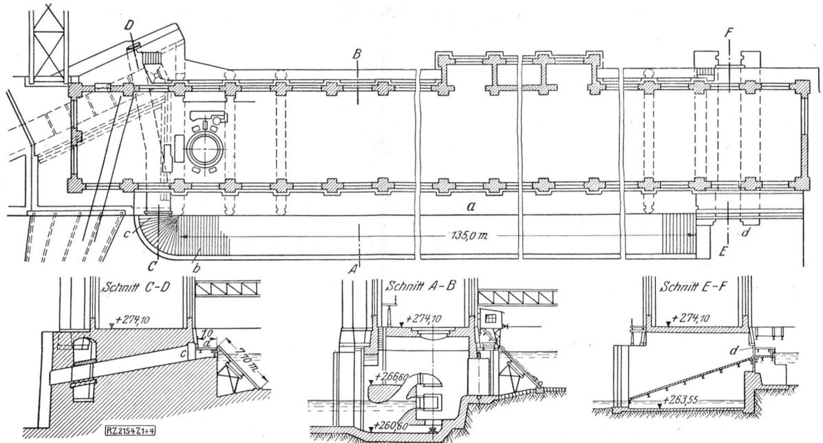
Abb. 1—4. Anordnung des Rechens, der Reinigungsmaschine und der Schwimmstoffabführung in der Wasserkraftanlage Rheinfelden. Maßstab 1:625.
