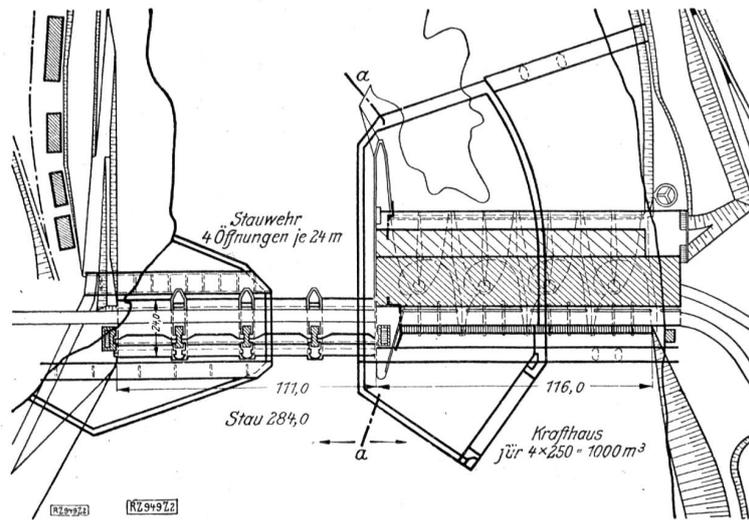
Abb. 2. Lageplan des Stauwehres und des Maschinenhauses.
