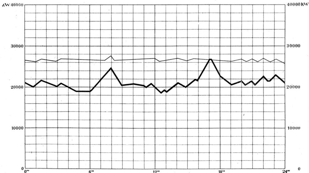
Abb. 3. Ausgleichwirkung der Speicherherde auf die Gesamt-Belastungskurve eines Elektrizitätswerkes mit Jahresspeicherbecken
