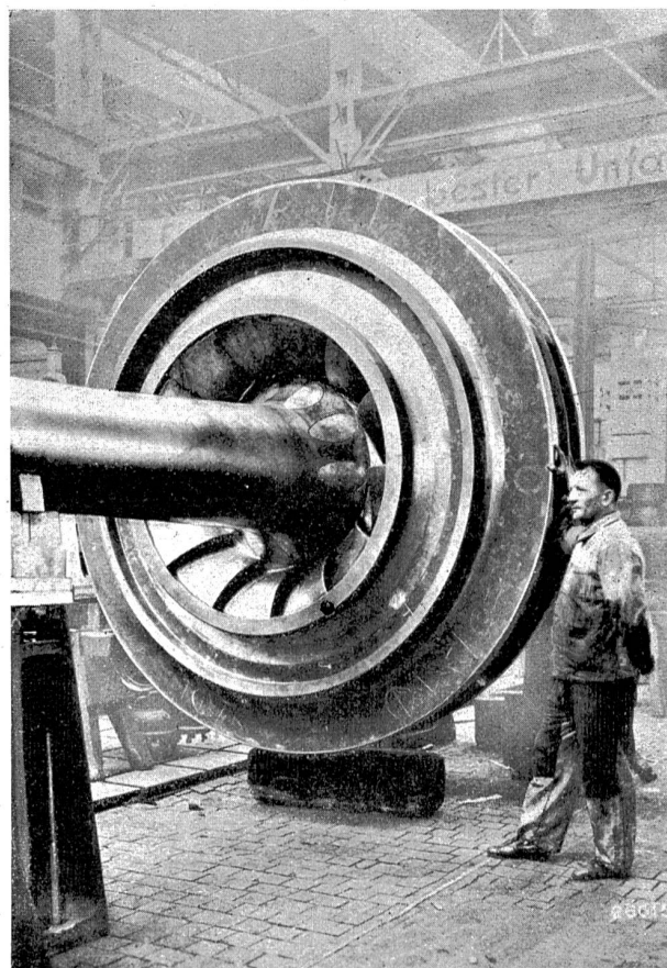
Abb. 3. Laufrad für eine Speicherpumpe in Niederwartha mit einer Fördermenge von 12 000 Liter in der Sekunde.
