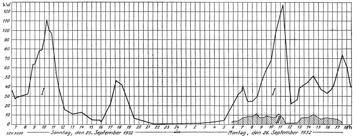
Abb. 53 In Hochdorf bestimmtes Belastungsdiagramm (gemessen mit Ampèremeter beim Verteiltransformator, inkl. alle Verteilverluste) für einen Sonntag und einen Montag von 83 Kochherden mit 300 kW Anschlusswert (wovon einer mit 18 kW Anschlusswert) und 32 Motoren mit 70 kW Anschlusswert. Fläche I: Kochherde. Fläche II: Motoren (am Sonntag ausgeschaltet); die Motorenkurve beruht auf approximativen Mittelwerten.
