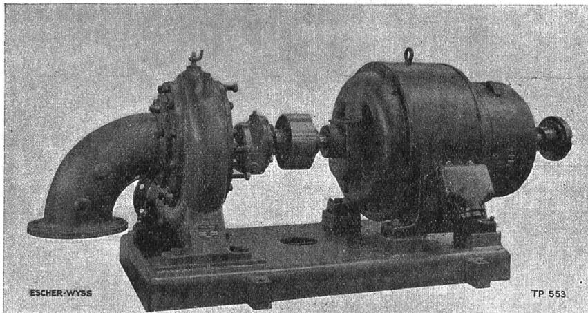
Einstufige Hochdruckpumpe mit geschweißter
