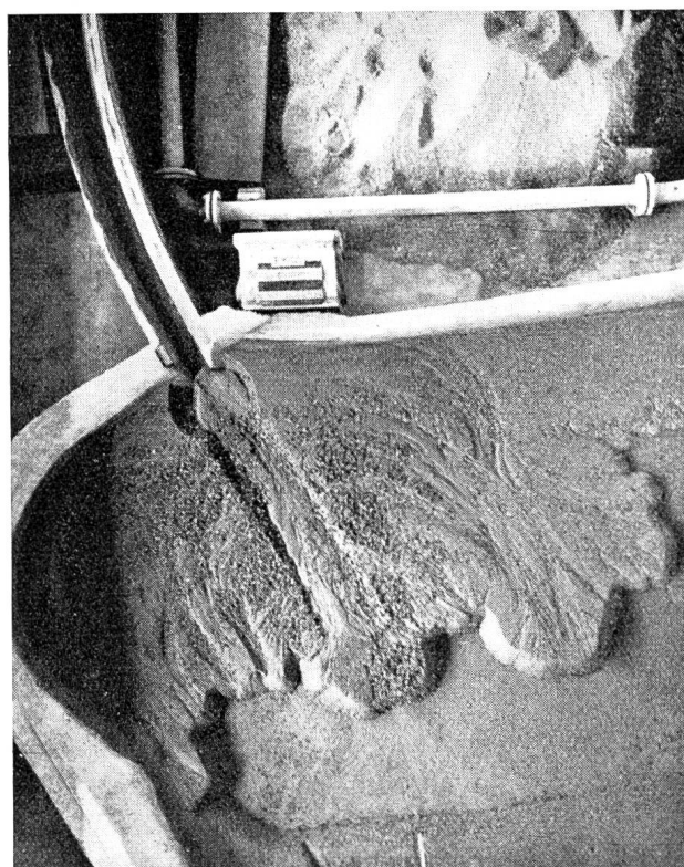
Abb. 89b Durchbruch des Deltas, Räumung des Bachbettes.
