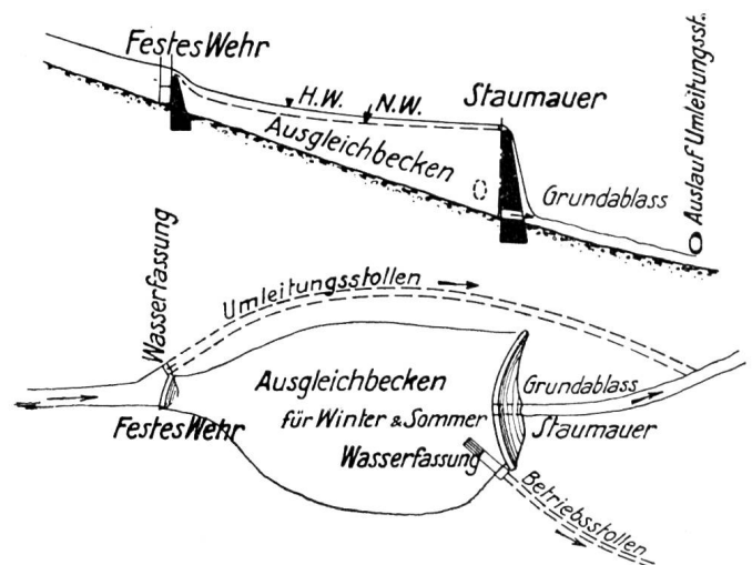
Abb. 121 Anordnung mit Umleitungsstollen.
