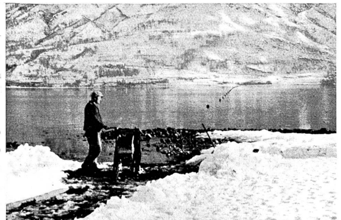
Abb. 107 An Schwimmern aufgehängter Messdraht. (Maggia-Delta-Aufnahme).
