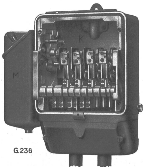
Fig. 23 Motorantriebenes Kontaktwerk (Fr. Ghilmetti & Cie. A.-G. Solothurn). Mécanisme de contact à commande par moteur (Fr. Ghilmetti & Cie, S. A., Soleure).
