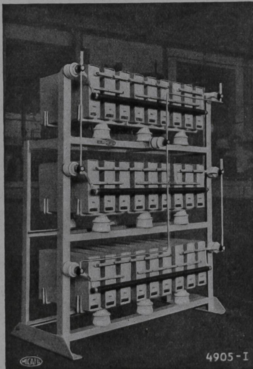
Hochspannungs-Nepolin-Kondensatoren-batterie für Innenraumaufstellung, mit Entladewiderständen. Leistung 270 kVar 2300 V 50 Hz
