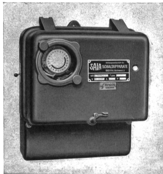
Fig. 40 Stufensperrschalter mit drei verzögerten Schaltstufen (Aktiengesellschaft für Schaltapparate SAIA, Bern). Interrupteur de blocage à couplage graduel avec trois échelons à enclenchement retardé (S. A. des Interrupteurs Automatiques SAIA, Berne).
