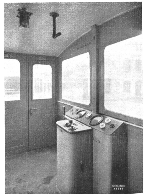
Abb. 5 Führerstand einer modernen Akkumulatortrakomotive; idealer Ausblick ringsum; einfachste Bedienung.
