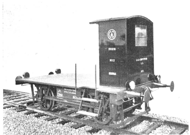
Abb. 4 Akkumulatoren-Kleintraktor 16 PS, Zuggewicht 48 t auf 23% Steigung.
