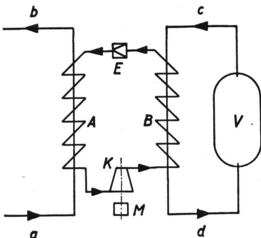
Fig. 7a Kaltdampf-Wärmepumpe
