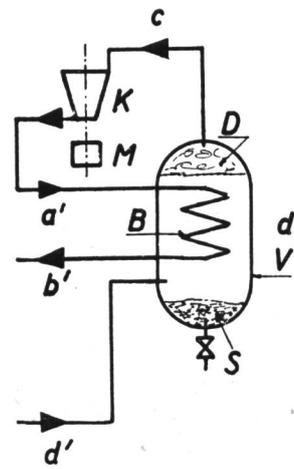
Fig. 7c Eindampf-Wärmepumpe
