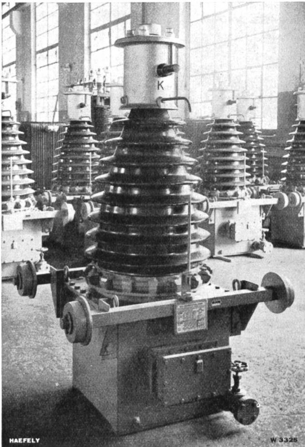
Fig. 14 Messgruppe für 60 kV Nennspannung, 152 kV Prüfspannung, 50 Hz.
