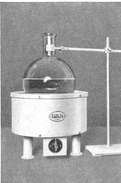
Fig. 21 Heizgerät für Glaskolben und Retorten.
