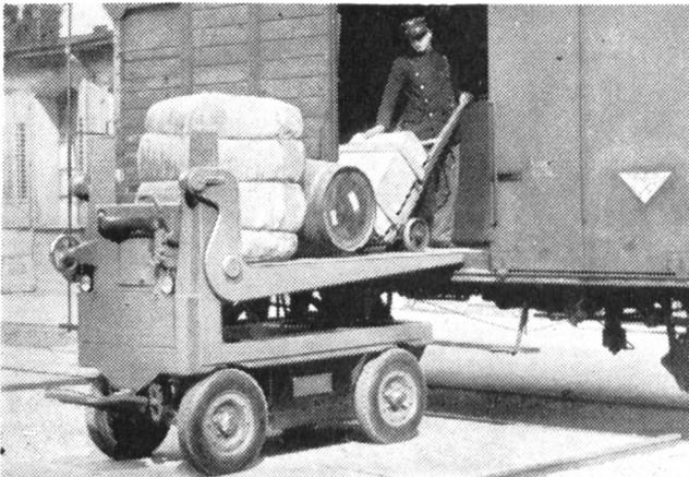
Fig. 23 SIG-Elektro-Plattformkarren mit Hubbrücke.
