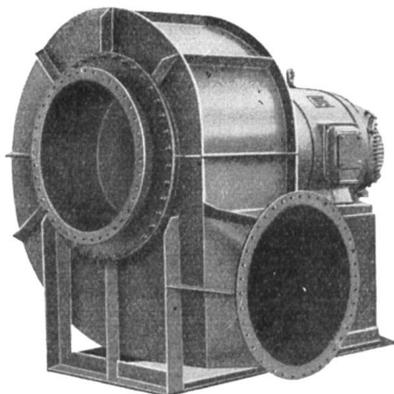
Fig. 19 Ventilator in gasdichter Ausführung für 2 Atm Ueberdruck.
