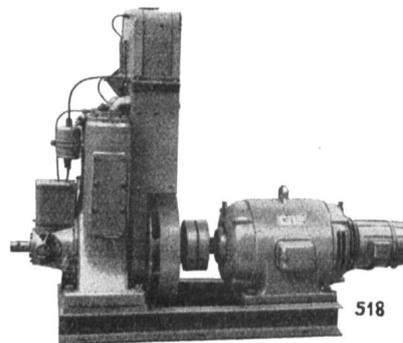
Fig. 12 Diesel-Elektro-Notstromgruppe mit Erregermaschine. 7,5 kVA, 380/220 Volt, 50 Per.
