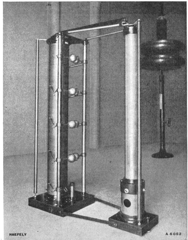
Fig. 15 Stoßspannungsanlage für Industrieprüffeld, 50 kV, 1,5 kW/sec
