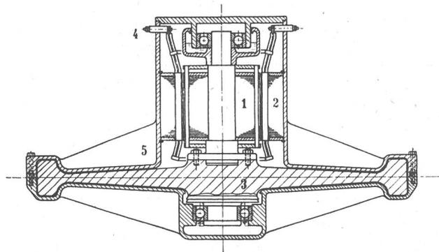
Fig. 9 Querschnitt durch den Elektro-Gyro.
