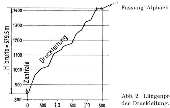
Abb. 2 Längenprofil der Druckleitung.
