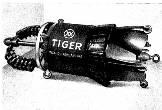
Abb. 5 Entkalkungsmaschine TIGER TW III/500 mit Wasserantrieb, zur Reinigung von Rohren aller Art mit starkem Kalk- und Rostbelag.
