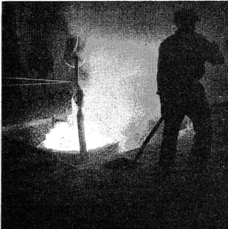
Fig. 12 Anstich des 4-t-Ofens in der Giesserei Monteforno.
