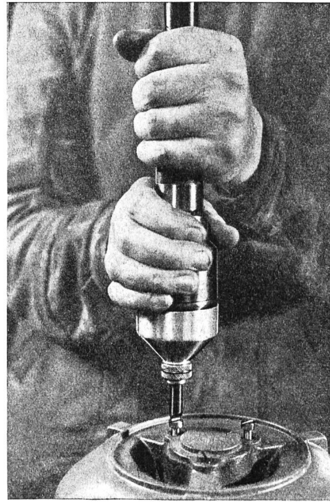
Abb. 13 Elektromotorisch angetriebener Schraubenzieher. Arbeitsablauf: a) Aufsetzen der Klinge auf den Kopf, der in das Loch eingesteckten Schraube. b) Einziehen der Schraube (Bild). Die Hand gleitet vom Einstellring zum Bremsring und bewirkt durch leichtes Bremsen desselben die Drehung der Klinge. c) Durch entsprechendes starkes Bremsen (oder einstellbaren Auslöser) kann die Schraube um Bruchteile einer Umdrehung festgezogen werden. (Werkaufnahme O. Suhner AG, Brugg.)
