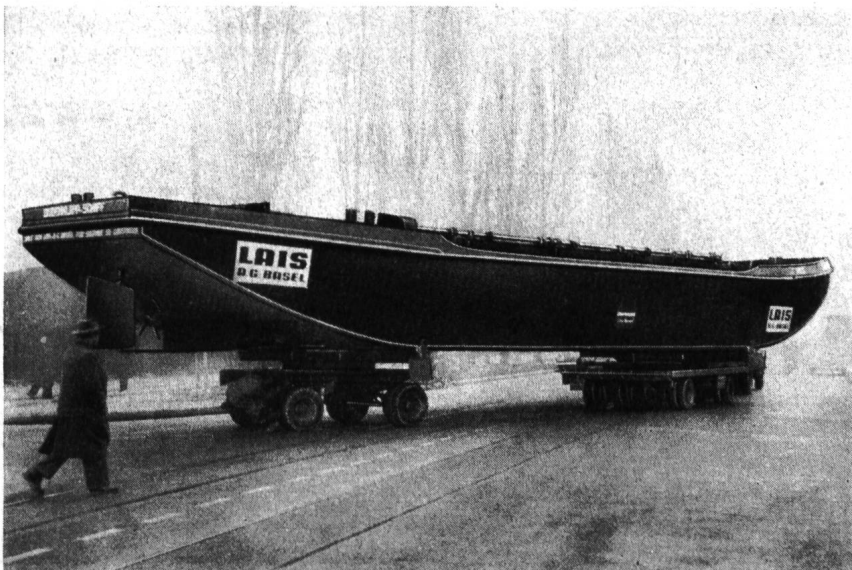
Lastmotorschiff «Rhône 2» auf dem Straßentransport von Basel nach Lausanne-Ouchy Das Schiff wurde für doppelten Verwendungszweck gebaut: 1. als Bodenklappschiff und 2. als Transportschiff für Greiferauslad
