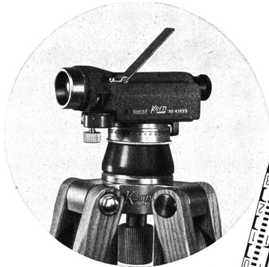
**Bau-Nivellier-Instrument GK O**
