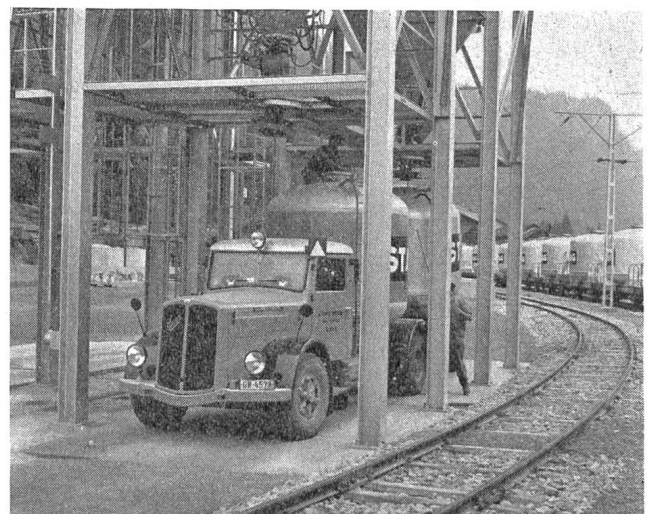
Abb. 5 Lastwagenzug mit 2 Aluminium-Transportbehältern à 7 t Ladegewicht beim Beladen auf der Umschlagstelle in Ilanz; im Hintergrund Rh.-B.-Zug mit Behälterwagen à 13 t Nutzlast
