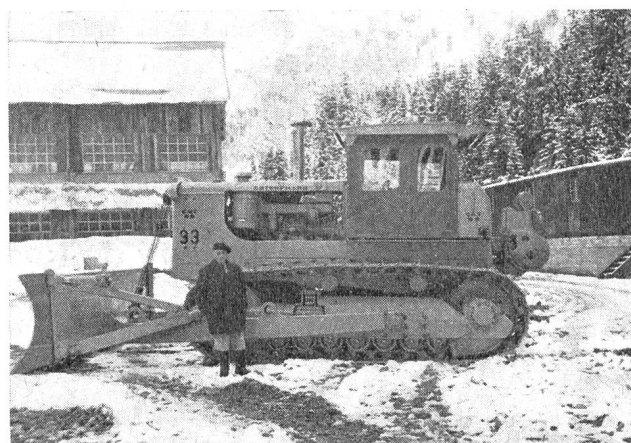
Abb. 13 Caterpillar-Bulldozer D 9 Gewicht: rd. 32 t Motorenstärke: 286 PS Zur Zeit größte Einheit auf dem Weltmarkt
