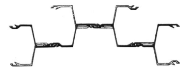
Die Symmetrie der Schloßverbindung ermöglicht ein Umstellen der Bohlen zu beliebigen Eckbildungen
