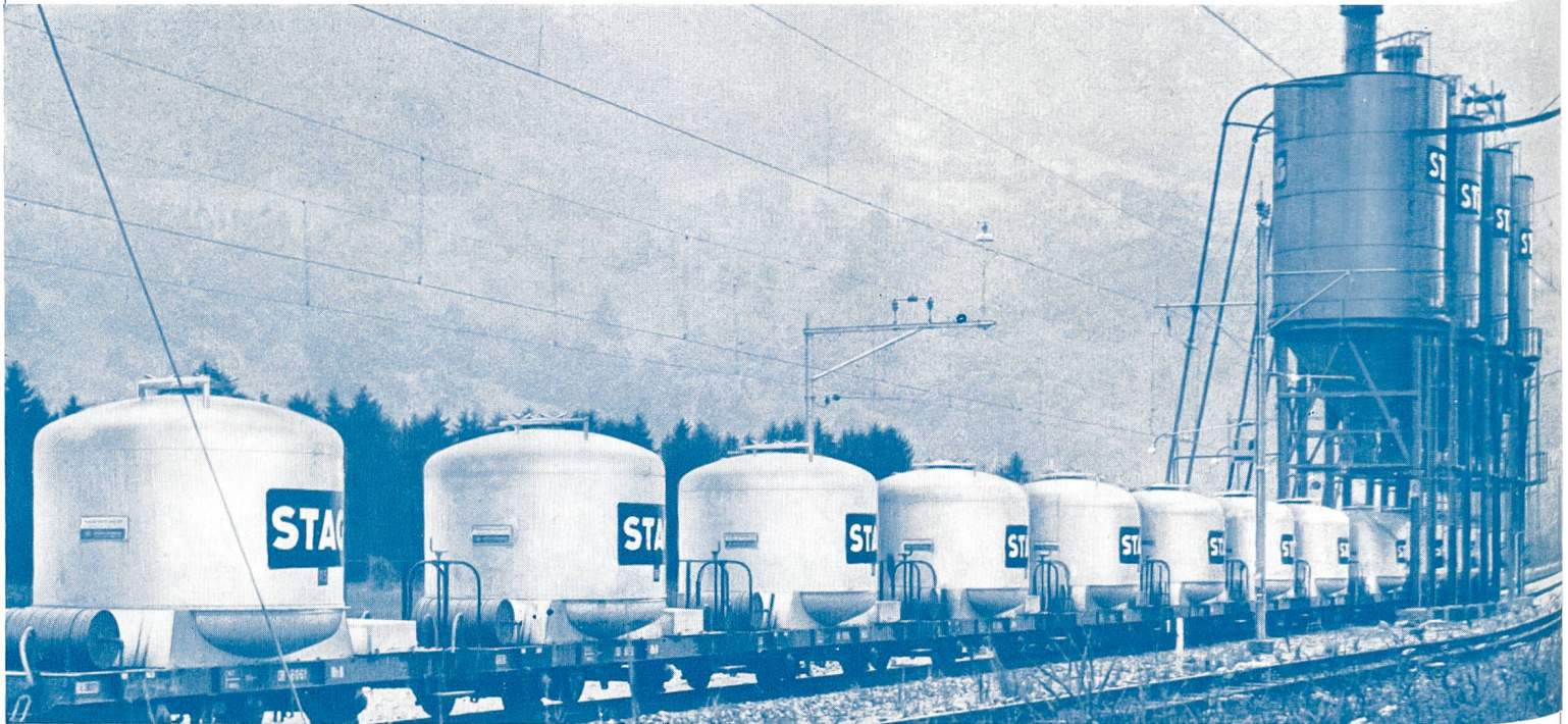
Umschlagsanlage der STAG in Landquart: Umschlag von SBB- in RhB-Silobahnwagen. 4 Silos à je ca. 200 t = 800 t Fassungsvermögen seit Frühjahr 1956 5 Silos à je ca. 200 t = 1000 t Fassungsvermögen
