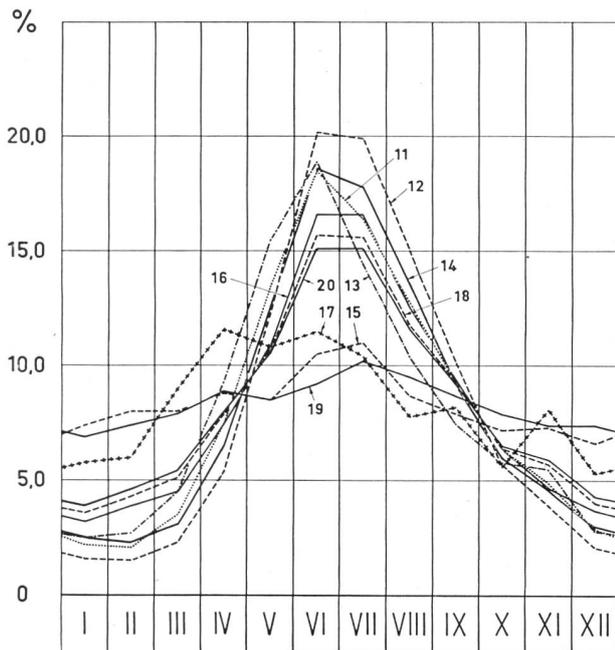
Bild 6 Jahreszeitliche Verteilung der Abflußmengen. Monatsabflußfrachten, ausgedrückt in Prozenten der Jahresfracht. Die Numerierung der Gebiete ist diejenige von Kolonne 1 in Tabelle 1. Jahresreihen gemäß hydrographischem Jahrbuch 1957
