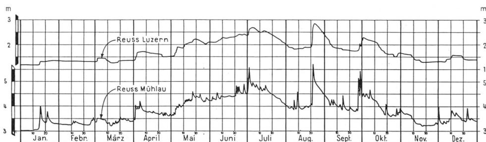
Bild 9 Verlauf der Wasserstände der Reuß in Luzern und in Mühlau im Jahre 1954
