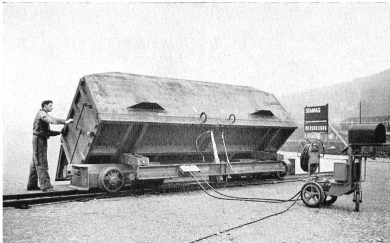
**Stollenwagen 10 m<sup>3</sup> Inhalt**, im Einsatz bewährte, robuste Konstruktion
