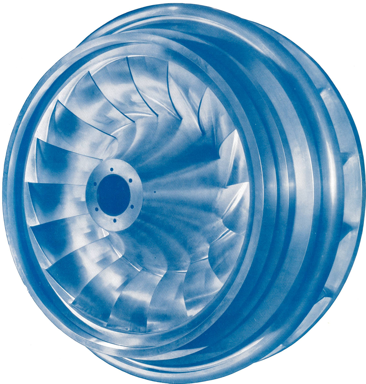
Laufblad für HD-Francis-Turbine der Zentrale Fionnay
