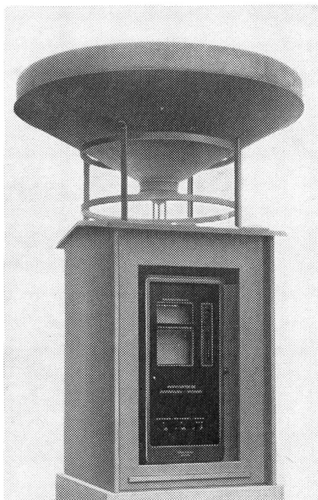
Niederschlagsintensitätsschreiber zur Aufzeichnung der Niederschlagsmenge/Minute und der Niederschlagssummen
