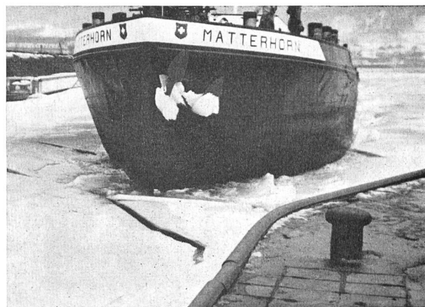
Bild 14 Zum Eisbrechen eingesetztes Motorschiff (Photo Kraftwerk Birsfelden)
