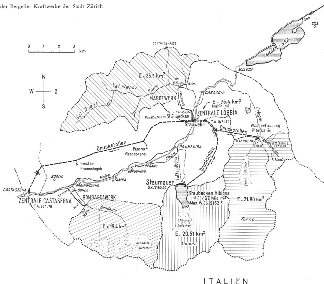
Bild 3 Übersichts-Lageplan der Bergeller Kraftwerke der Stadt Zürich
