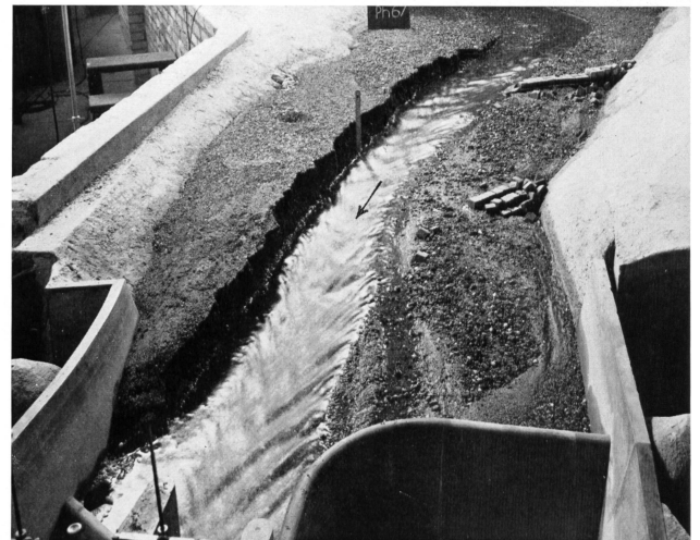
Bild 11 Wasserfassung Averser Rhein (Kraftwerkgruppe Valle di Lei — Hinterhein). Spülversuch des verlandeten Stauraumes. Blick auf Erosionsrinne nach 15 Std. Spülung mit Q = 6 m 3 /s. Fludlaufwärts zwei Leitbühnen zwecks Ablenkung gegen rechtes Ufer. Abspülung etwa 3000 m 3 . Einzugsgebiet 42,5 km 2 . HHQ ≈ 170 m 3 /s. Jahreswasserfracht ≈ 62 Mio m 3 . Modellmaßstab 1:50.
