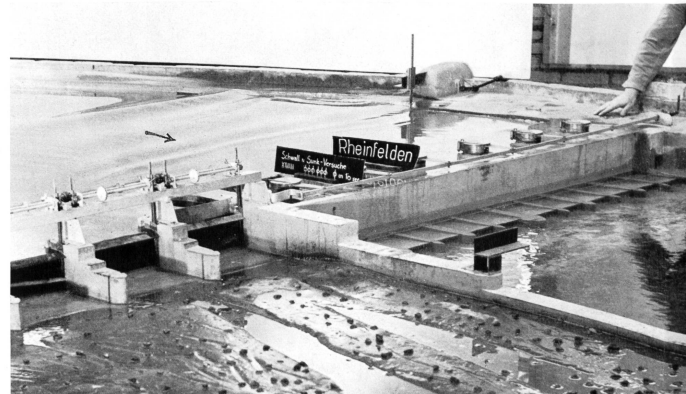
Bild 7 Kraftwerk Rheinfelden. Standort des neuen Kraftwerkes 200 m flussabwärts des bestehenden Wehres; Überprüfung des Neubauprojektes auch hinsichtlich des Bauprogrammes. Die Photo zeigt einen Schwallversuch bei plötzlichem Schließen der Turbinen mit Q = 1200 \text{ m}^3/\text{s} . Modellmaßstab 1:70.
