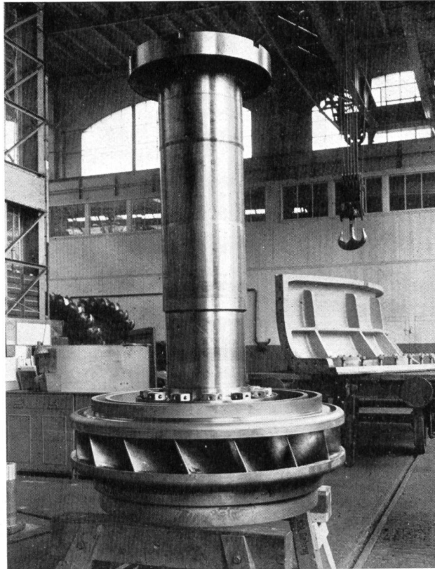
Bild 8 Extremer Francis-Langsamläufer für hohes Gefälle; Laufrad für eine der Turbinen des Kraftwerkes Fionnay/Mauvoisin, 62 800 PS, H etwa 455 m (1956) Photo Escher-Wyß
