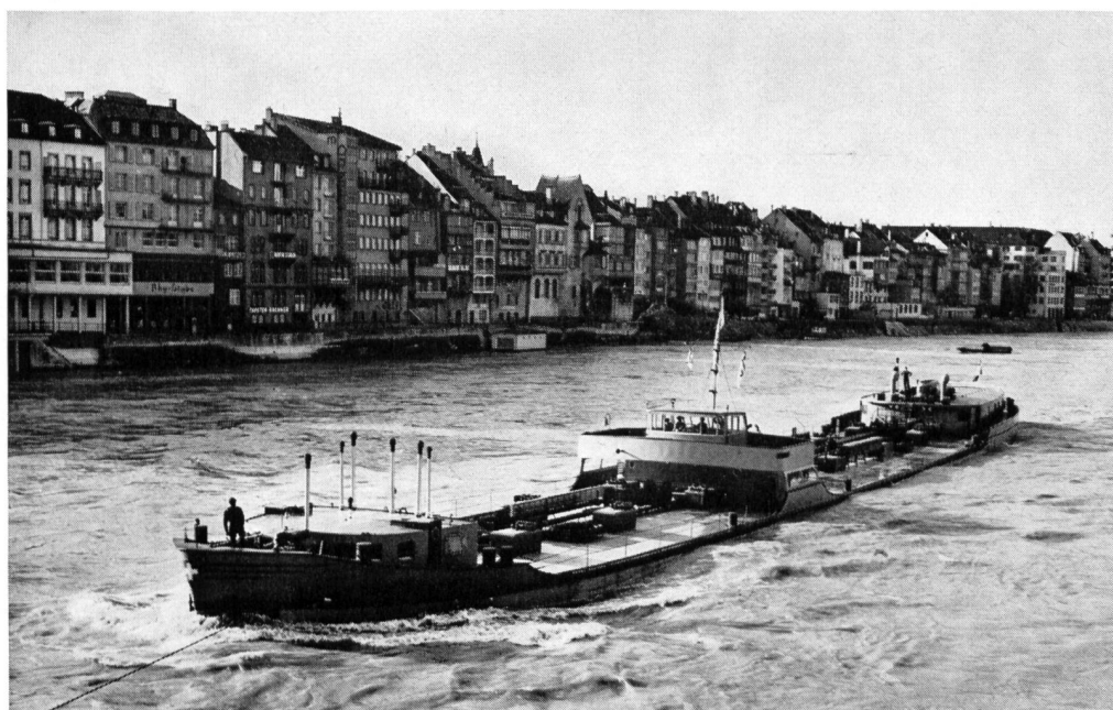
Bild 3 Ein «übergroßes» Motorschiff MTS «Piz La Margna» (1800 t, 1500 PS) bei der Fahrt durch Basel (Brä Tansschiffahrt AG)
