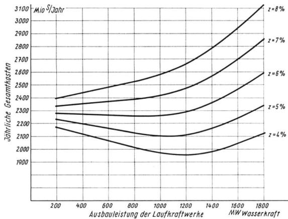
Fig. 4 Ermittlung des optimalen Anteiles der Laufkraftwerke an der Deckung des österreichischen Strombedarfes
