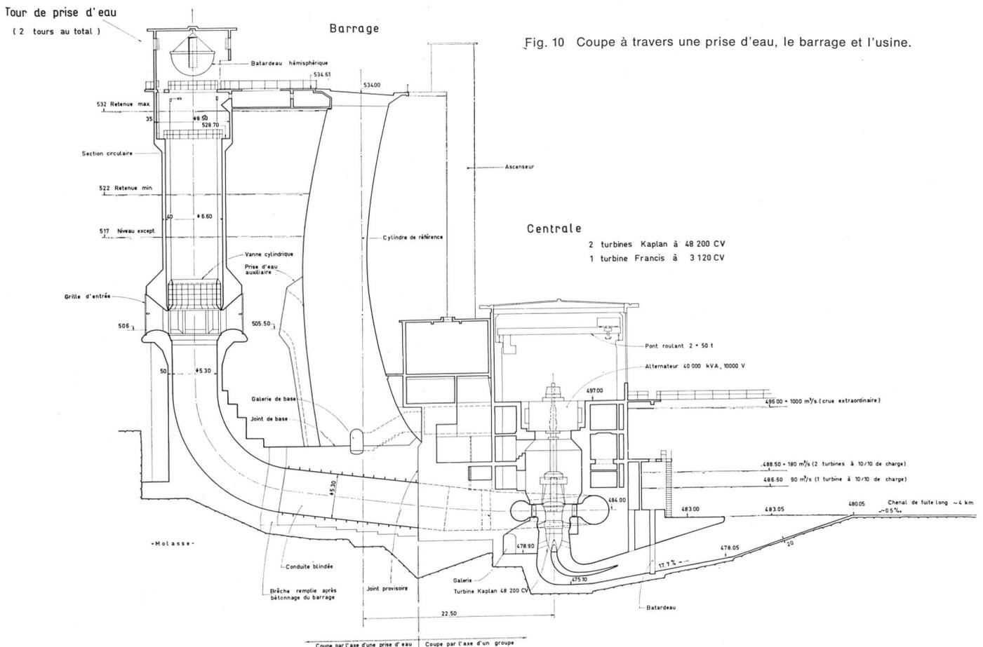
Fig. 10 Coupe à travers une prise d'eau, le barrage et l'usine.
