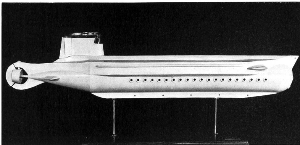
Fig. 5 Modell des «Mesoscaphe» im Masstab 1:33⅓
