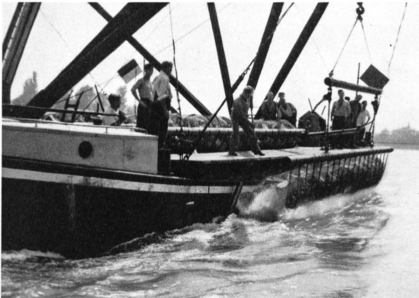
Fig. 2 Abwerfen einer Drahtsenkbrücke von der mechanisierten Senkbrücke
