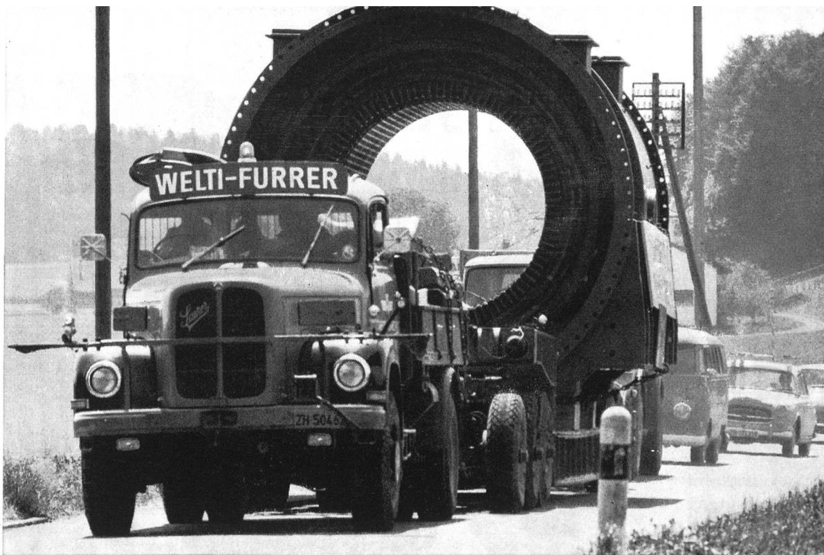
Transport eines Stators der Maschinenfabrik Oerlikon von 87 Tonnen Gewicht, 5,7 m Länge, 4,2 m Breite und 3,7 m Höhe für das Unterkraftwerk Breite/Nürens Dorf der Nordostschweizerischen Kraftwerke.
