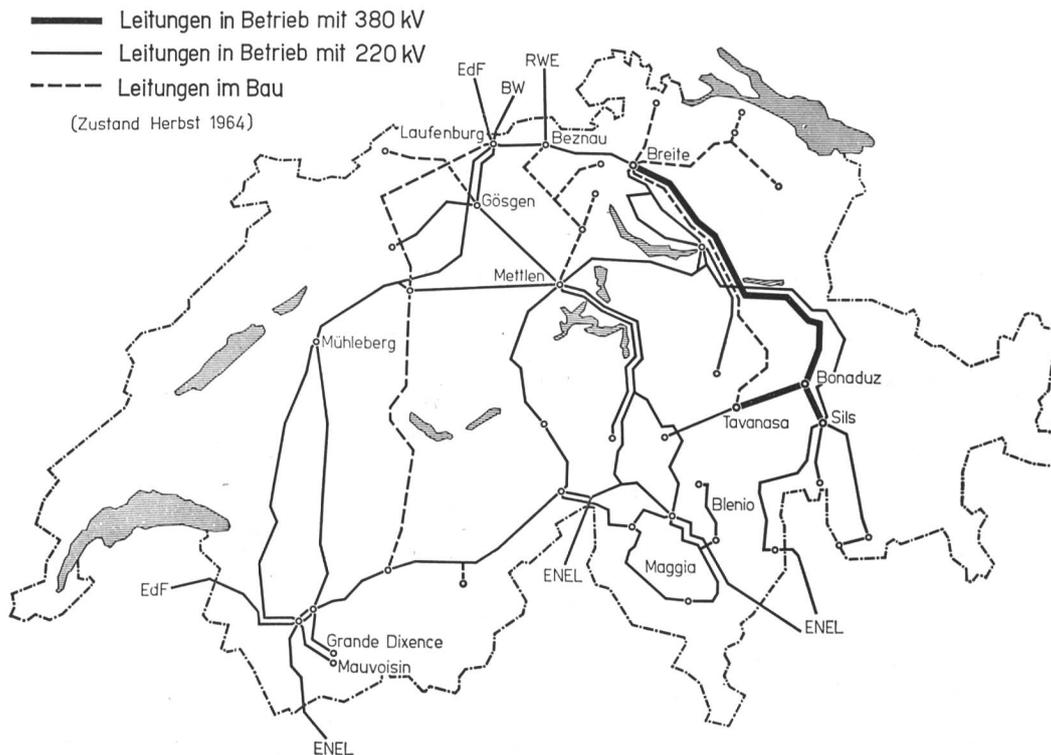
Fig. 1 380 kV- und 220 kV-Leitungen des schweizerischen Höchstspannungsnetzes; Ausbautzustand Ende 1964
