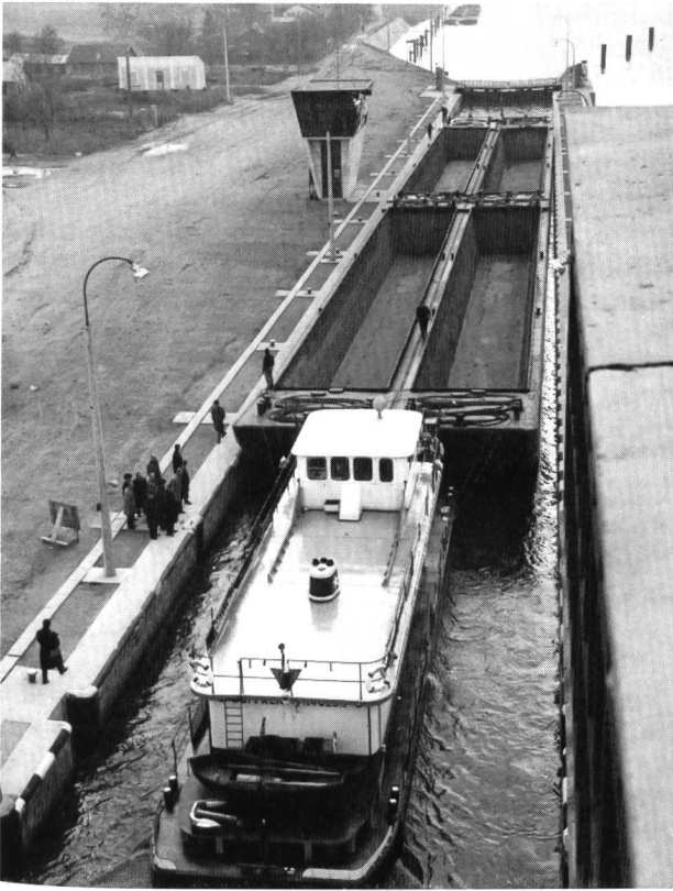
Fig. 3 Pousseur de marchandises générales «Suffren» de la Cie. des sablières de la Seine
