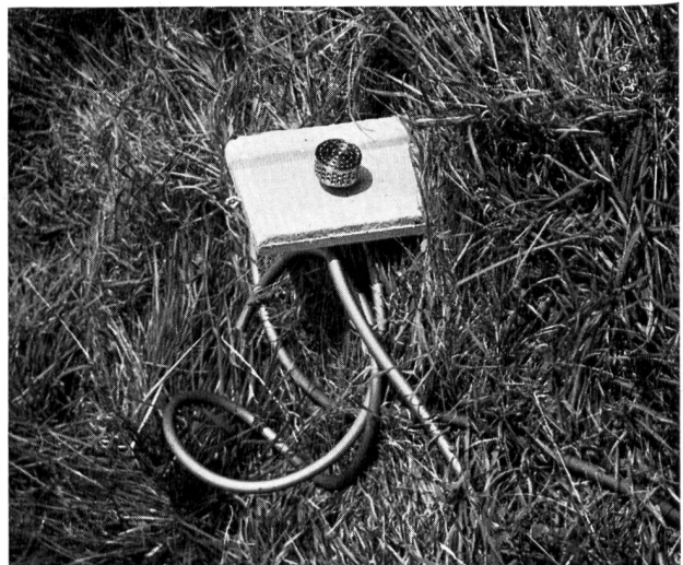
Bild 7 Schwimmer von unten; sichtbar ist der Messing-Filterkorb.
