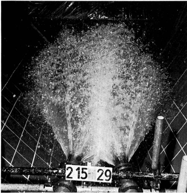
Fig. 4 Vidange des barrages. Modèle réduit des vannes à jet creux. Essais en laboratoire, à demi-ouverture. (Photo EPUL)
