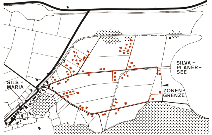
Bild 81 Quartier Suot-Ovas, Sils i.E. Von dieser Ebene würde ein zu grosser Teil in eine dreigeschossige Bauzone eingeteilt; ohne zusätzliche Massnahmen wäre eine ungeordnete Streubauweise zu erwarten;
