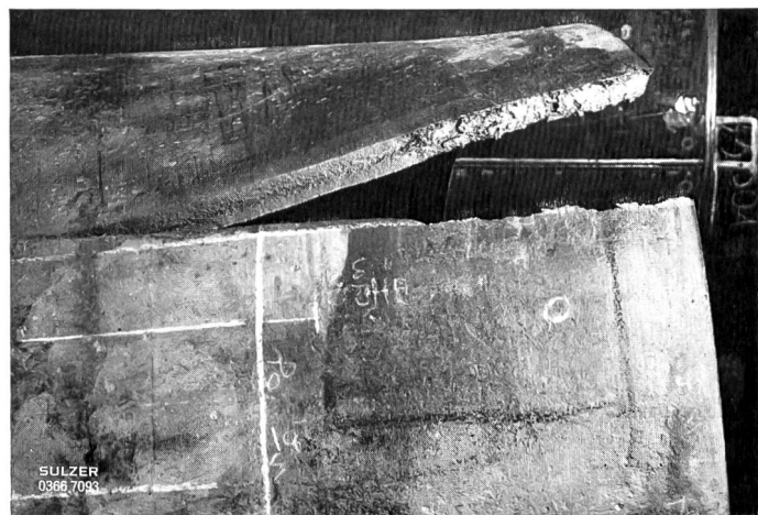
Bild 7 Beim Abpressversuch entstandener vorzeitiger Rohrbruch (Mischbruch), ausgehend von örtlich zerstörtem Material infolge Wassergasschweissung.
