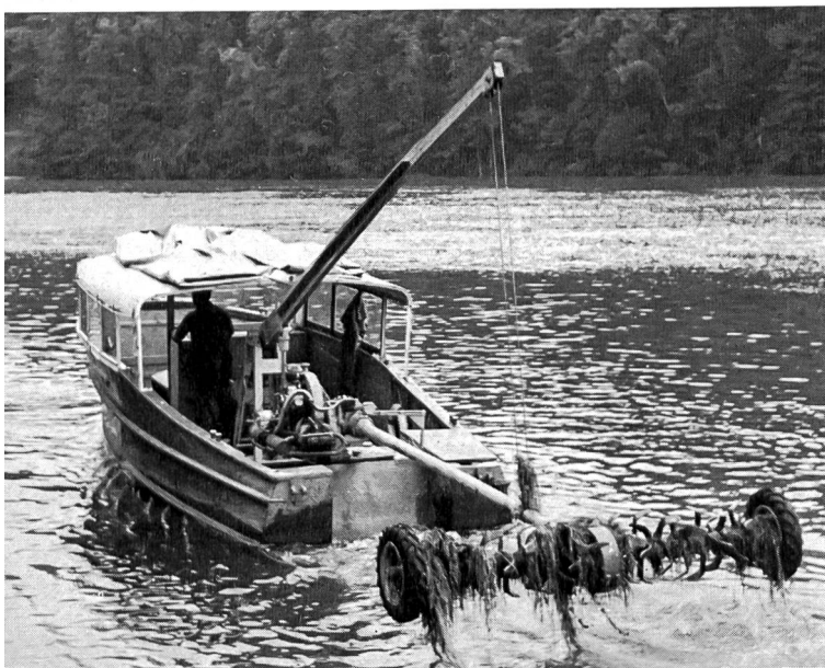
Bild 9 Algenfräse Kraftwerk Rheinau 1967; starkes Eisenboot mit Hydraulik und Bucher-Egge als Fräsgerät
