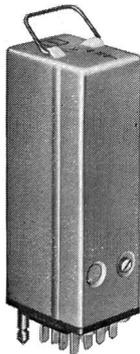
Das Tonfrequenz-Multiplex-Steuersystem T St 20/30 gestattet die gleichzeitige Übertragung bis zu 30 Informationen wie Steuerbefehlen, Befehlsquittierungen oder Betriebszustandsmeldungen sowie Analogwerten über eine Leitung. Sender und Empfänger können an beliebigen Orten in die Verbindungsleitung eingeschleift werden; die Speisung der Sender kann über die Leitung erfolgen.
