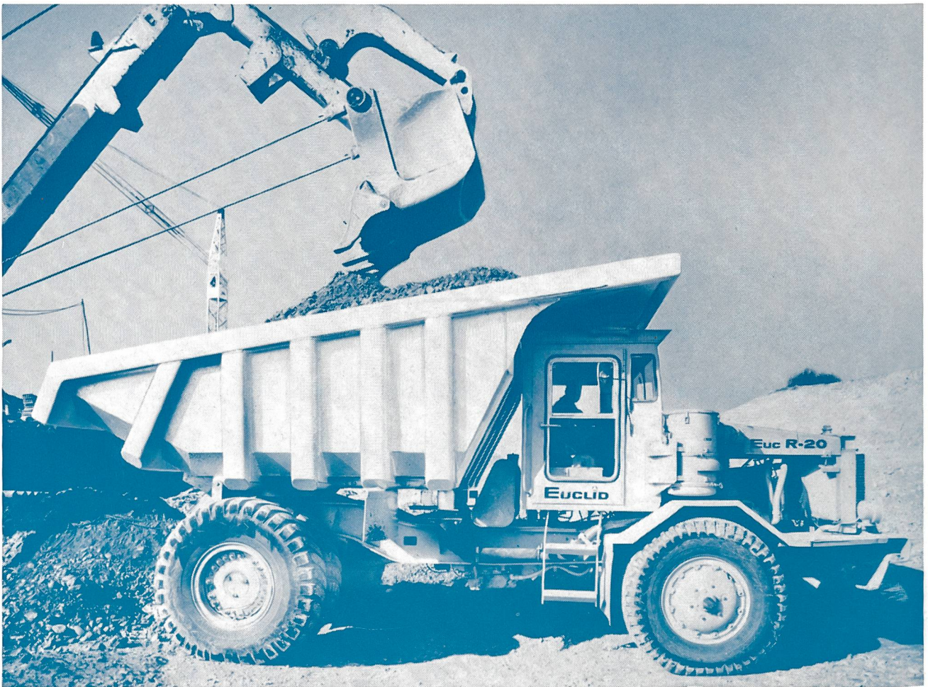
Beheizte Kippmulde aus Leichtmetall-Speziallegierung auf einem Euclid-Rückwärtskipper im Einsatz.
