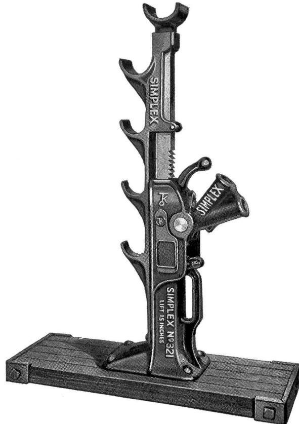
**321**, Kabeltrommelwinde 10 t mit 5 Auflagestellen für Trommeln von 50 bis 240 cm Ø und mehr. Weitere Modelle 5 und 10 t mit Stahl- oder legiertem **Aluminiumgehäuse** und hydr. Trommelböcke bis 45 t mit verschiedenen Hubhöhen sind lieferbar.
