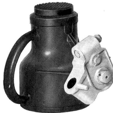
**1510-5010**, **mechanische** Präzisionshebeböcke 13,5 bis 45 t, 127 bis 227 mm Hub, mit Stahl- oder legiertem **Aluminiumgehäuse**. Die ideale Transformatorenwinde mit präziser Betätigung, sehr leicht und kompakt gebaut. Der Kolben wird sich auch nach langer Belastungszeit oder durch Erschütterung nie senken.
