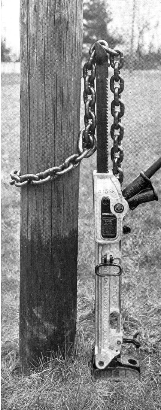
**A-1538**, die einzige Mastenwinde mit legiertem **Aluminiumgehäuse**. Wiegt nur 28 kg mit 56 cm Hub und 15 t Tragkraft, daher besonders handlich. Der Gelenkfuss passt sich den Masten und Bodenverhältnissen an. Die Winde eignet sich für Holz- und Betonmasten.
