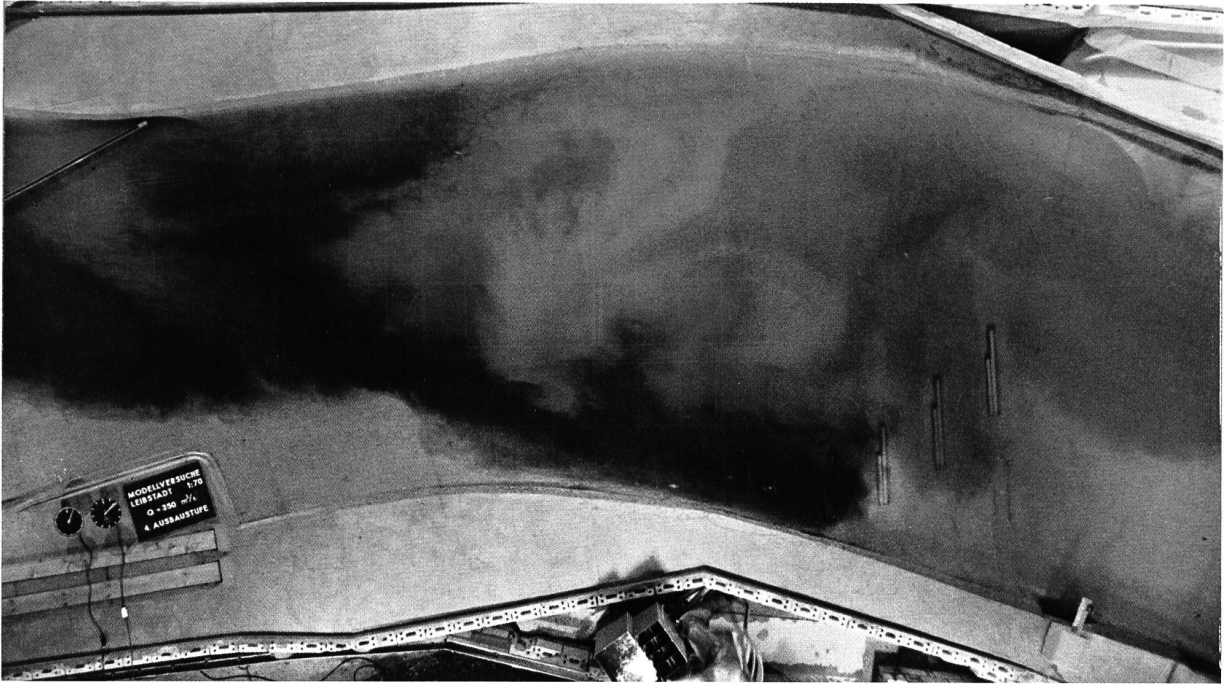
Bild 4 Kernkraftwerk Leibstadt: Fassung und Rückgabe von 120 \text{ m}^3/\text{s} Kühlwasser bei einem Rheinniederwasser von 350 \text{ m}^3/\text{s} . Untersuchung der Rohrlösung im hydraulischen Modell 1:70.
