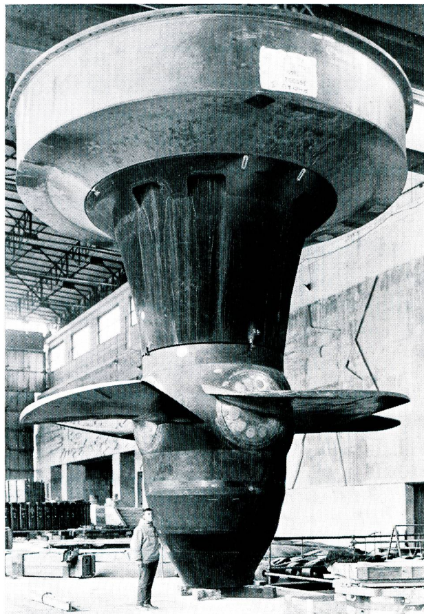
Figure 2 Turbine Kaplan pour l'usine de Rhinau
